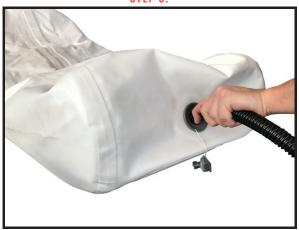
· INSERT AND SECURE PUMP END
